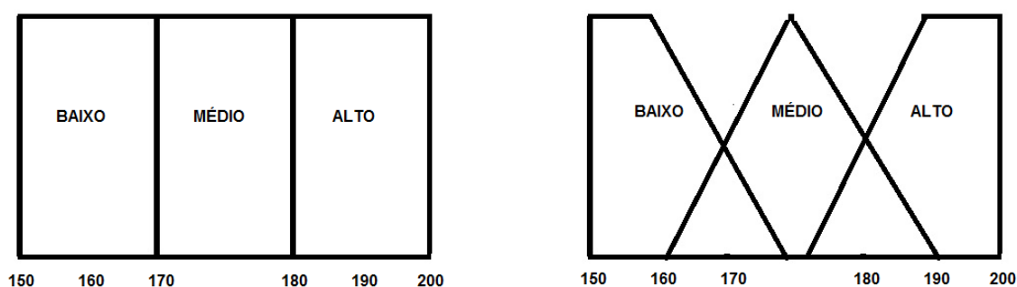
Figura 1 Representação geral de conjuntos de altura de uma pessoa, sob a forma de Conjuntos Crisp (lógica convencional) e Conjunto Fuzzy (a direita)
